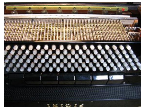
Sonderanfertigung für PIGINI Konzertakkordeon mit 8 Bassmikros. special model : bass microphone board with 8 capsules for PIGINI concert accordion.
