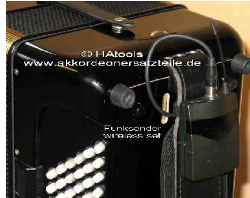
Anschlußbuchse oben für Betrieb mit Funksender. output connector in top position for wireless operation.
