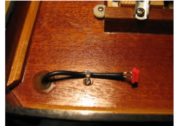
Bassdurchführungskabel Stimmstockseite, verlegt + fixiert. Bass cable, fixed at bellows side.
